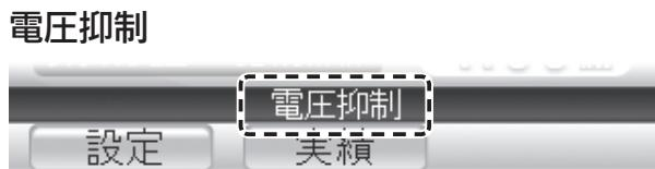
電圧の上昇を防ぐため、出力を抑えています。
